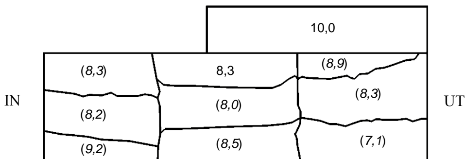
Figur 3.3.2.6 - Fuktkvot (%) i syll (2012-06-22), hus 6. Kursiva värden inom parentes betyder att det fanns kåda på plåten efter att provet torkats i ugn, vilket innebär att viktminskningen på grund av vattenavgivning överskattats. Verklig fuktkvot är med andra ord lägre än vad dessa siffror anger.
